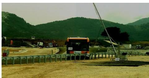
Ensayo: TB51 (vehículo pesado de 13.000 Kg. a 70 Km/h y 20°)
